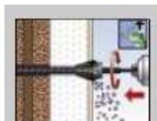
Phase 3: installer MTH THERMAX en utilisant une perceuse doté d'embout hexagonal
